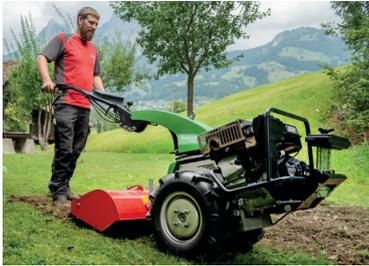
Die Rapid Bodenfräse fräst gewachsene oder vorbearbeitete Böden, zerkleinert die Bodenbestandteile und durchmischt die Horizonte. Das Einsatzgebiet des Bodenbearbeitungsgeräts ist breit und reicht von der Grundbodenbearbeitung, über Saat- und Pflanzbeetanlagen bis hin zur Einarbeitung von organischem Material oder Düngern.
