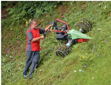
Mit dem Rapid Rex arbeiten Sie auch dort effizient, wo bisher nur Sensen im Einsatz waren. Dank nur 85 kg Gewicht und tiefem Schwerpunkt lassen sich Hanglagen bis zu 120% Gefälle sicher bearbeiten. Mit der aktiven Holmlenkung ist präzises Manövrieren selbst in unwegsamem Gelände einfach und sicher.
